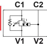
**BH 08****Blok hamujący****Overcenter valve single acting****Senkbremseventil einfachwirkend****BH 08**
